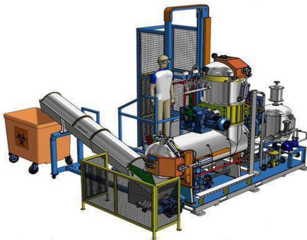
Hình 3.12. Hình ảnh tổng thể hệ thống khử khuẩn kết hợp nghiền cắt.
