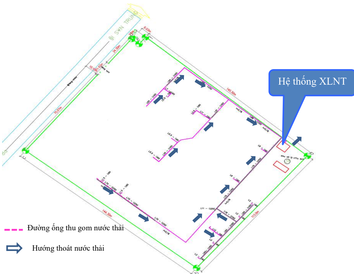
Hình 3.5. Sơ đồ hệ thống thu gom nước thải của TTYT huyện Hương Sơn (cơ sở 1) sau khi các công trình hoàn thành đầu nối
