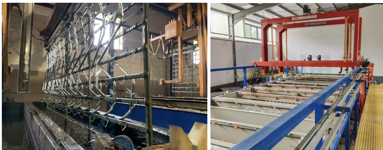
Hình 1. 6 Hình ảnh minh họa chuyên xử lý bề mặt với giá treo
